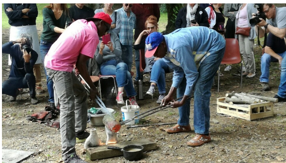
Atelier décirage, fusion, décoche : Démonstration par l'artiste Décirage ou fonte de la cire au feu de bois. Fusion du bronze et coulage de chaque pièce réalisée. Décoche après refroidissement .
