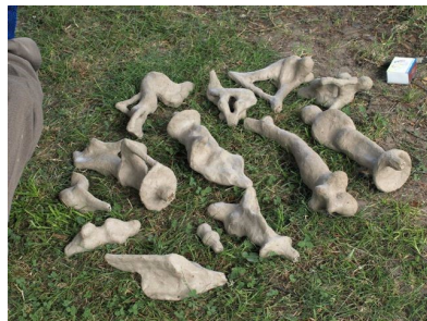
Atelier décirage, fusion, décoche : Démonstration par l'artiste Décirage ou fonte de la cire au feu de bois. Fusion du bronze et coulage de chaque pièce réalisée. Décoche après refroidissement .
