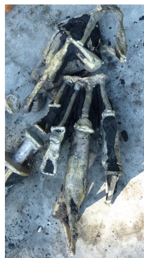
Atelier décirage, fusion, décoche : Démonstration par l'artiste Décirage ou fonte de la cire au feu de bois. Fusion du bronze et coulage de chaque pièce réalisée. Décoche après refroidissement .
