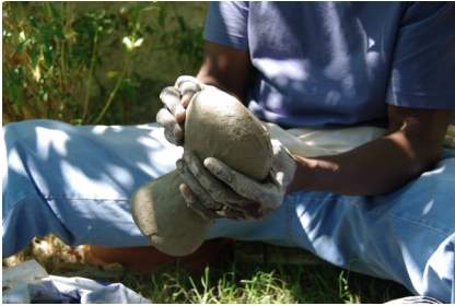
Atelier décirage, fusion, décoche : Démonstration par l'artiste Décirage ou fonte de la cire au feu de bois. Fusion du bronze et coulage de chaque pièce réalisée. Décoche après refroidissement .
